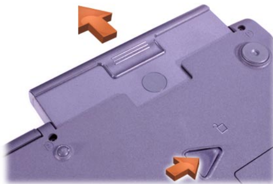
图 2-8：从电池槽中取出电池
